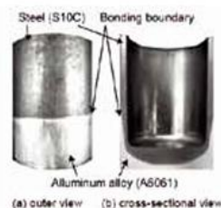
図1 鋼とアルミの後方押し鍛造接合事例
