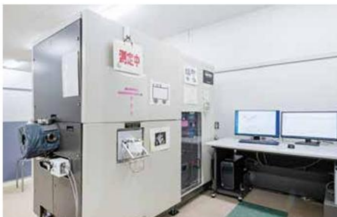
走査型X線光電子分光測定 ULVAC-PHI, inc. Quantera SXM-GS
