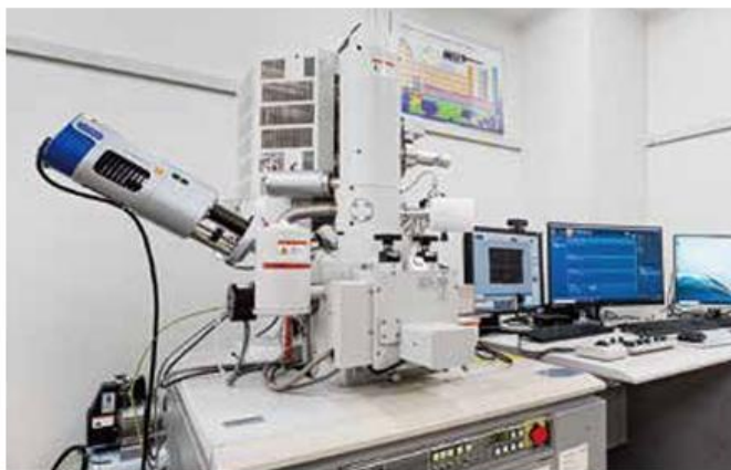
電解放出型走査電子顕微鏡 日立ハイテック S-4800
