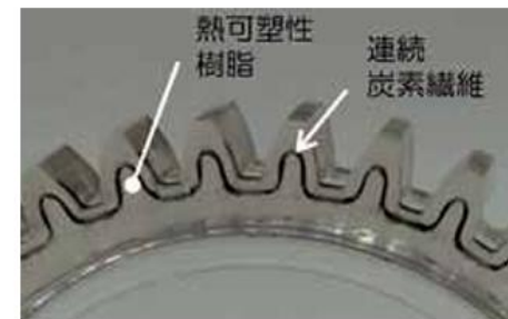
図2 連続炭素繊維をインサートした樹脂製歯車
