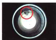
切粉が残留している例
